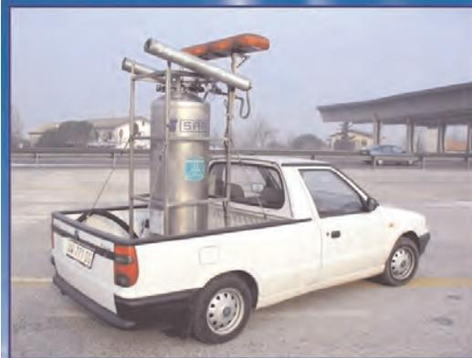
Передвижной азотный генератор ледяных кристаллов для рассеяния переохлажденных туманов
