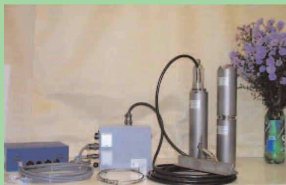
Общий вид широкополосного скважинного сейсмометра с регистратором
