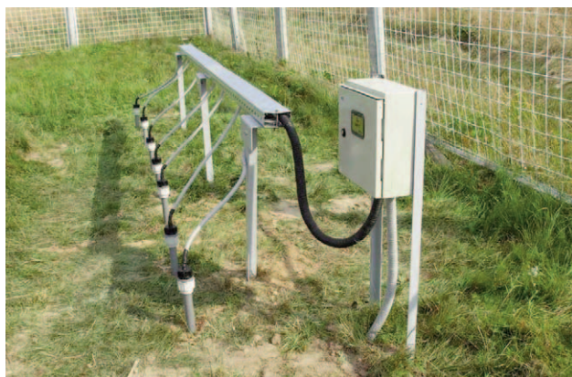
Термометры на глубинах: 0,2 м; 0,4 м; 0,8 м; 1,2 м; 1,6 м; 2,4 м; 3,2 м (Ярославский ЦГМС)
