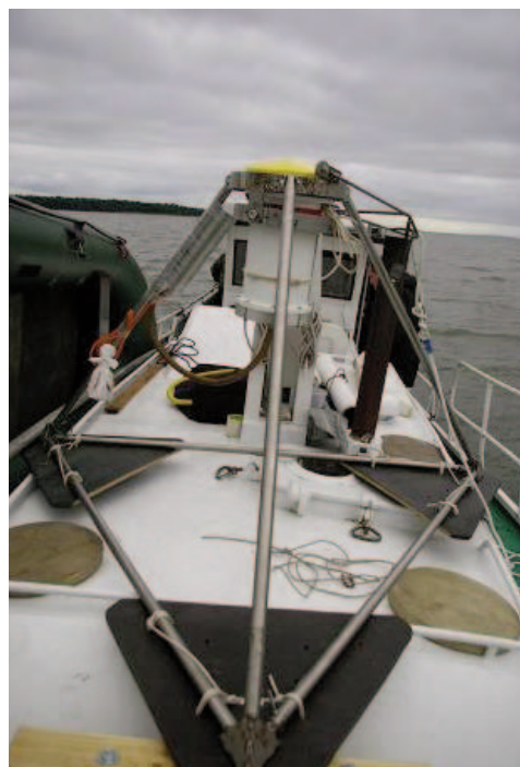
ADCP, подготовленный для установки на дне, на борту маломерного судна "Лапландия"
