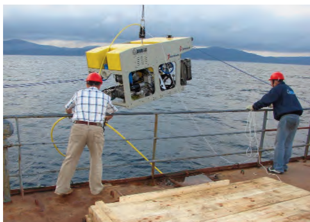
Исследование устьев скважин на Киринском нефтегазоносном месторождении с помощью ТПА «Comanche»
