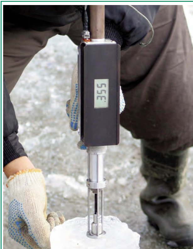
Определение динамической твердости ледникового льда
