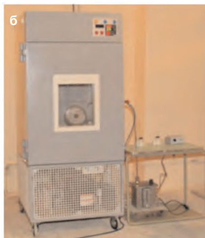
Внешний вид стенда: а – аэродинамическая труба с системой отбора пробы; б – облачная камера с системой регистрации ледяных кристаллов
