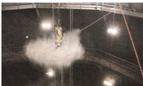
Факел распыла роторного распылителя ASC-A20-24
