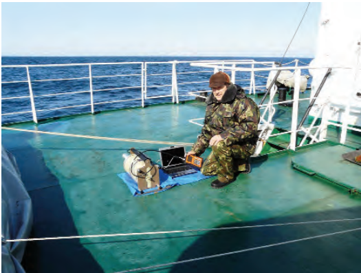
Измерение мощности дозы внешнего гамма-излучения
