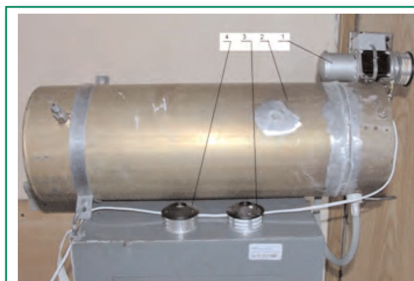
Лабораторный генератор мелкодисперсных гигроскопических растворов со сменными головками 75 и 25 мкм:
