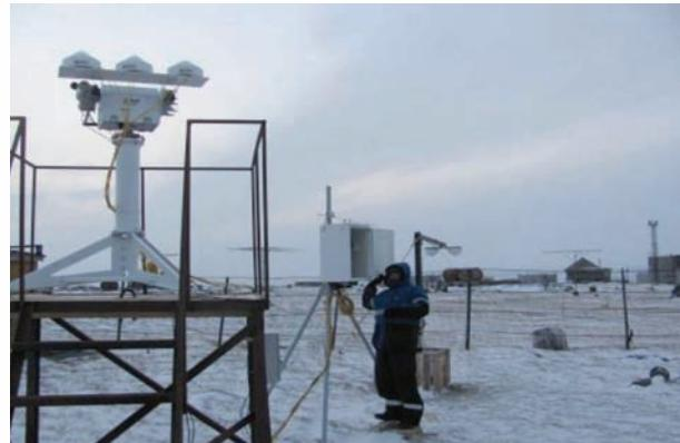
Настройка автоматизированного актинометрического комплекса (ААК) на ОГМС Диксон
