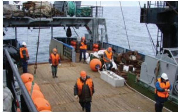
Установка автономной буйковой станции с борта
