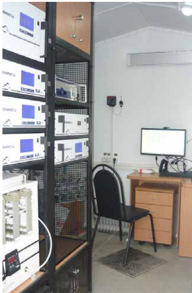
Автоматическая станция МР-28 по измерению загрязняющих веществ в атмосфере: А – общий вид; Б – приборная стойка
