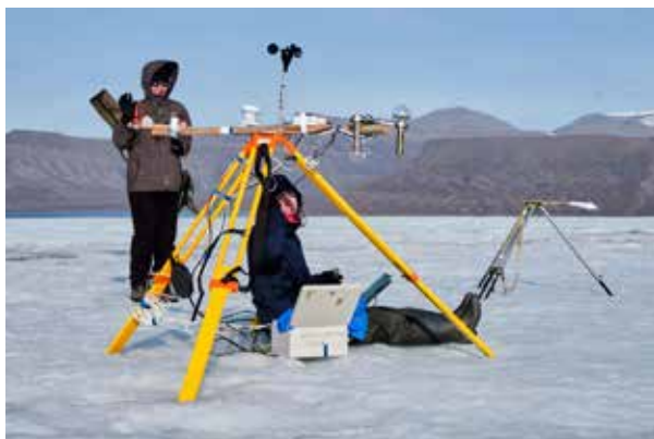
Установка и настройка оборудования временной теплосбалансовой мачты на леднике Альдегонда (фото М. Курапова)
