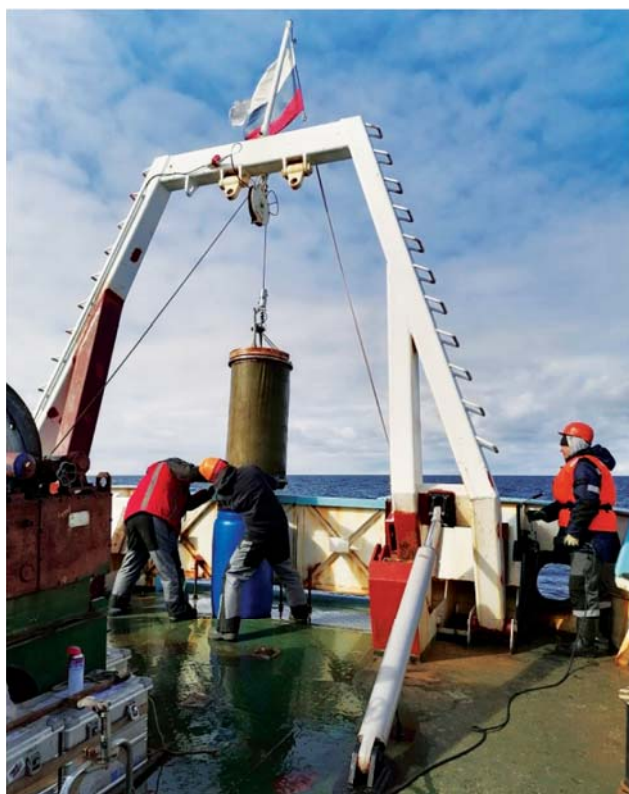
Отбор проб морской воды с разных горизонтов в районе затопления АПЛ К-278 «Комсомолец» с НИС «Профессор Молчанов»
