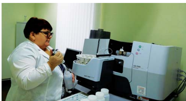
Измерение концентрации тяжелых металлов в воде атомно-абсорбционным методом с использованием высокочувствительного спектрофотометра АА-70000 в Верхне-Волжском УГМС
