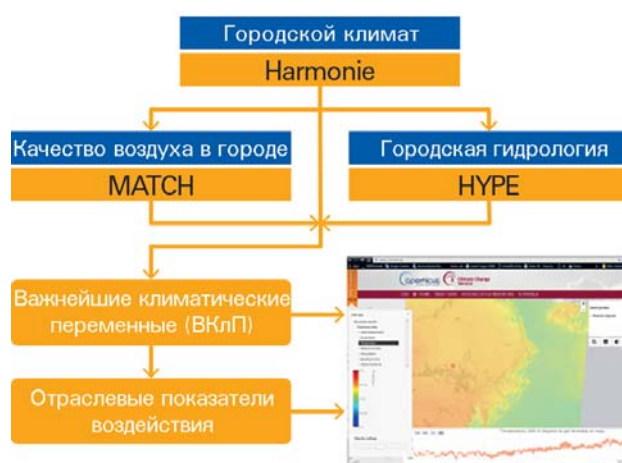
Рис. 1. Общая технологическая схема, отображающая подход с применением динамического даунскейлинга, используемый в UrbanSIS.
