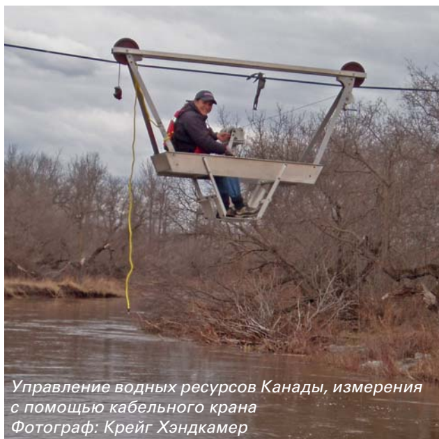
Измерение скорости водного потока Фотограф: Кейт де Смеш
