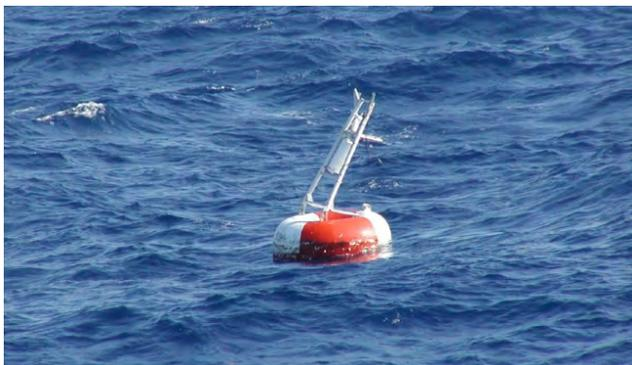
*Повреждённый буй ТАО с наклонившейся надстройкой. Источник: Б. Бернетт, NDBC, 2009 год (ГСБД-25).*
