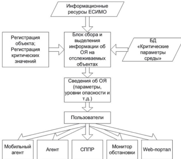
*Рис. Схема выявления опасных явлений*
