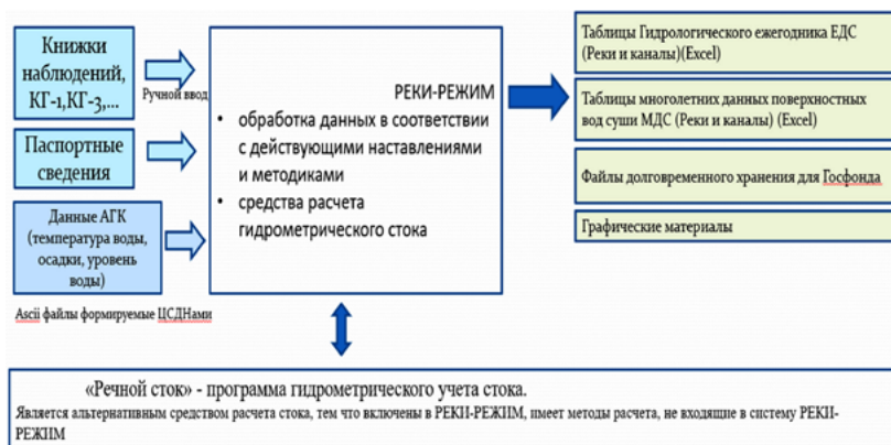
Рис. 1. Схема обработки гидрологических данных и формирование продукции системой РЕКИ-РЕЖИМ
