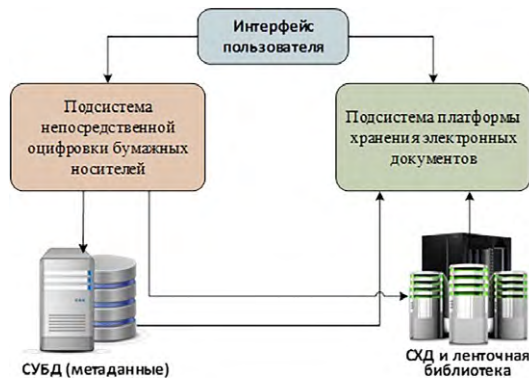
Рис. 3. Схема взаимодействия подсистем АИС ЭФОД
