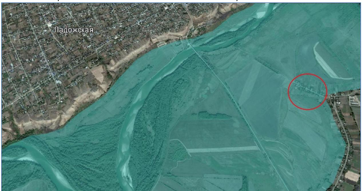
Рис. 3.7 Пример зоны затопления района населенного пункта Ладожская при уровне 10% обеспеченности с указанием опасных мест
