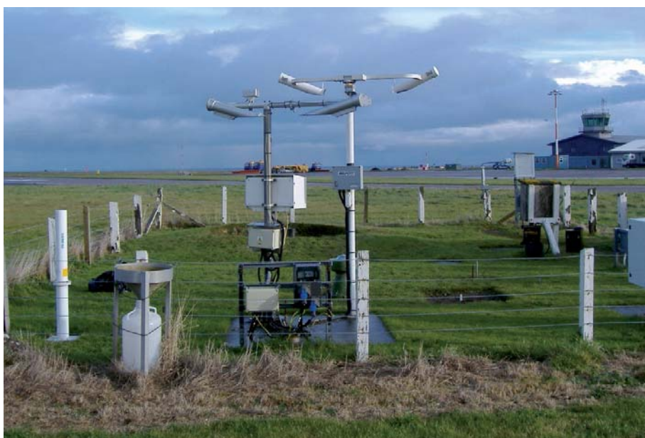
Типичная аэродромная система метеорологических наблюдений
