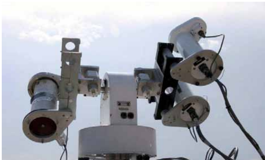
КПМН работает над обеспечением глобальной однородности измерений солнечной радиации с помощью пиргелиометров.
