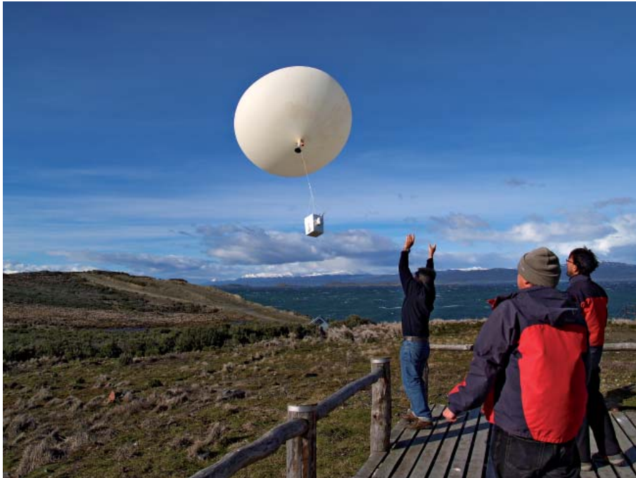
Рисунок 2 – Запуск озонозонта на станции ГСА в Ушуайя (Аргентина). Эти наблюдения, проводимые Национальной метеорологической службой Аргентины при поддержке Испанского метеорологического агентства и Национального института авиационно-космической техники, являются важным вкладом в мониторинг Антарктической озоновой дыры.
