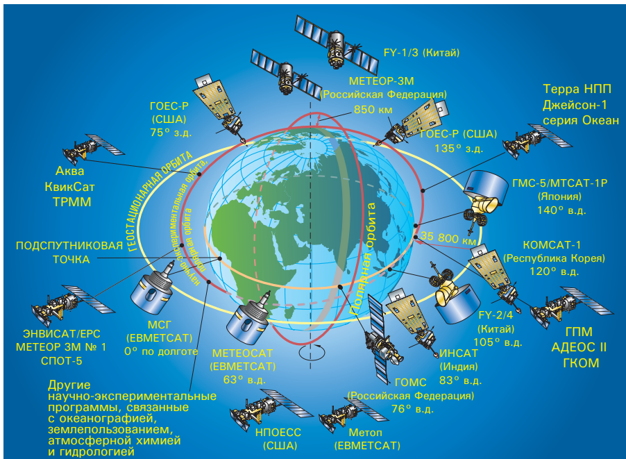
Рисунок 6 – Глобальная система спутниковых наблюдений ВМО, 2009 г.
