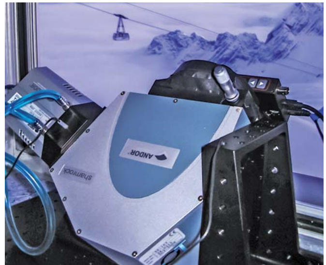
Спектрометр для измерения свечения атмосферы, установленный в здании на заснеженном высокогорном леднике вблизи альпийской вершины Цугшпитце
