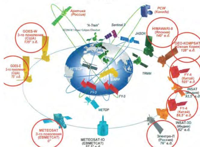
Текущее состояние космического компонента ИГСНВ: кольцо из 14 геостационарных спутников и разнообразные низкоорбитальные спутники Земли на различных орбитах
