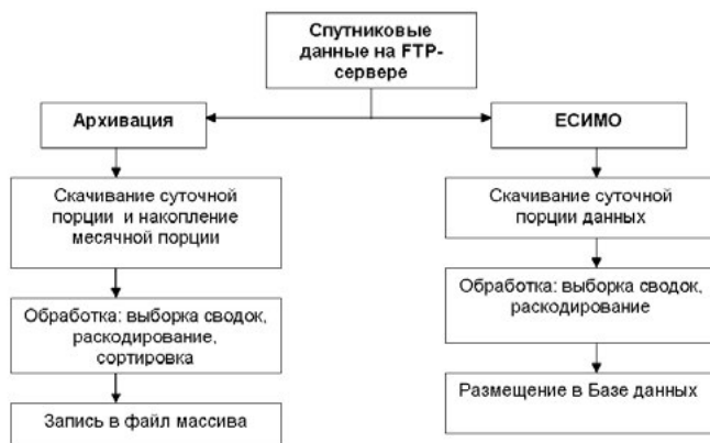
Рис. 1. Общая схема обработки спутниковых данных по температуре поверхности океана
