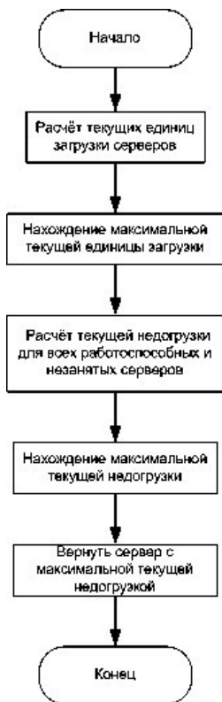
Рис. 3. Блок-схема алгоритма распределения нагрузки
