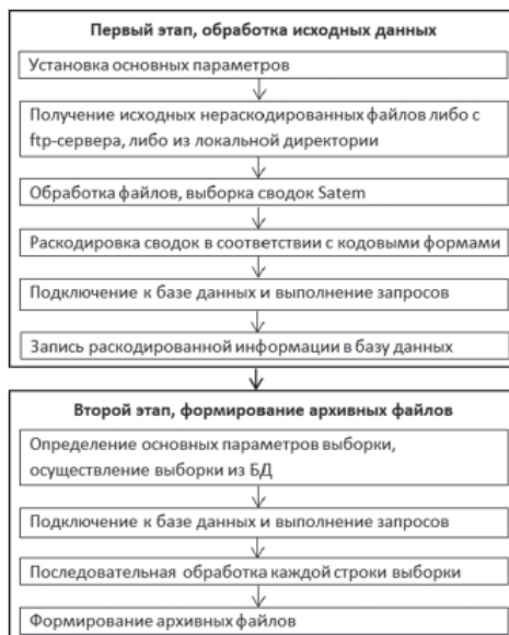
Рис. Схема обработки спутниковых сводок SATEM для получения архивных файлов
